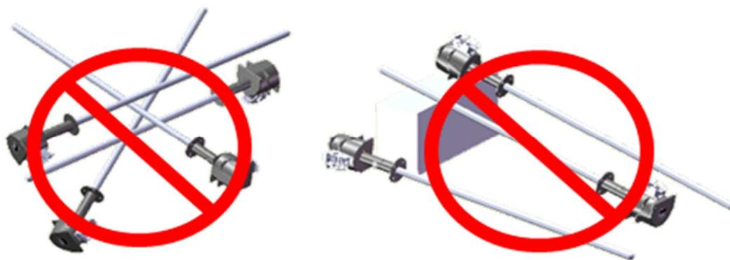
Les thermoplongeurs doivent être manipulés avec précaution et tout choc mécanique sur la gaine est absolument proscrit.
