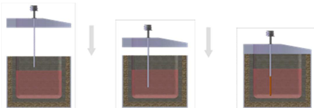
2- Le remplissage de l'étuve lorsque le thermoplongeur est déjà en place dans celle-ci. Le remplissage doit se faire de manière progressive et sans projection directe sur la gaine du thermoplongeur.
